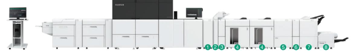
Vollständige Konfiguration: B 10.462 mm x T 1.104 mm x H 1.786 mm
